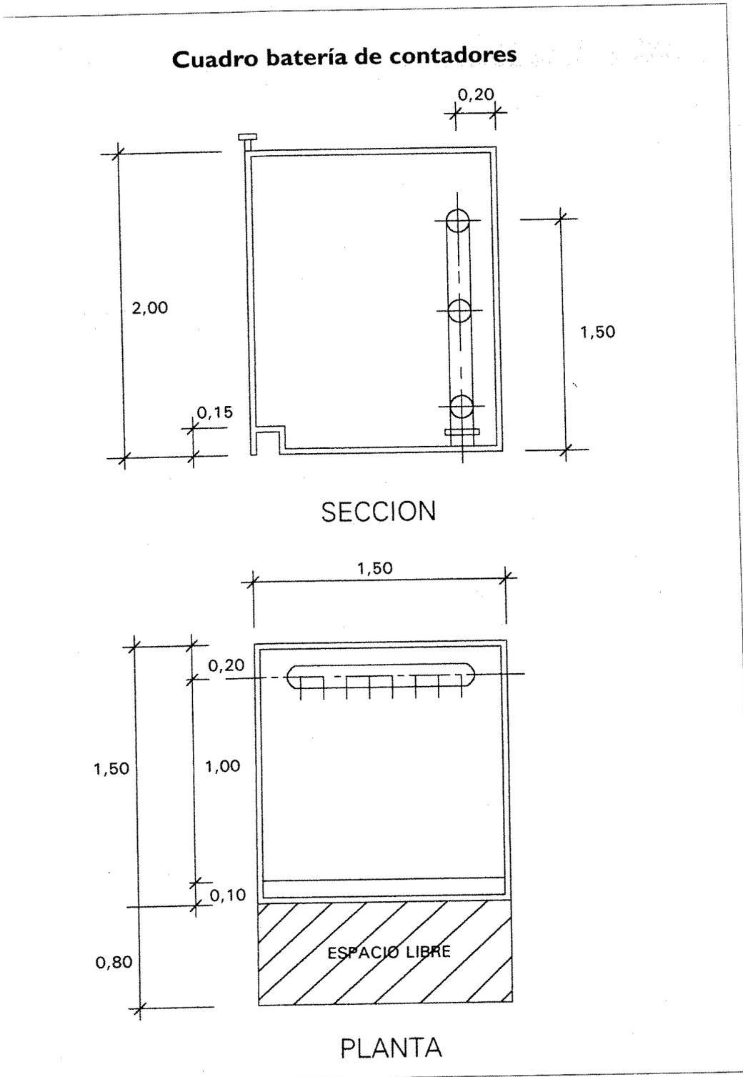
Las dimensiones del armario serán como mínimo las suficientes para permitir las operaciones de montaje, desmontaje y lectura de los contadores. En todos los casos, la altura libre de la zona de manipulación será como mínimo de 2 metros y un espacio libre frontal de 1 metro, medido desde la válvula de salida del contador.
